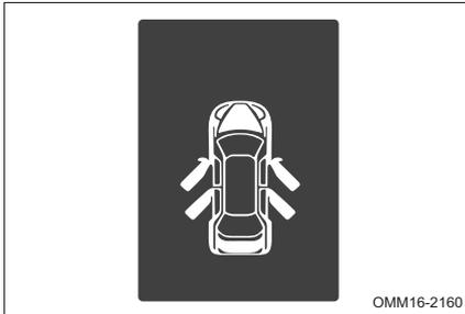
Если открыта какая-либо дверь, капот или крышка багажника, то на многофункциональном дисплее будет показано состояние четырех дверей, капота и крышки багажника.
