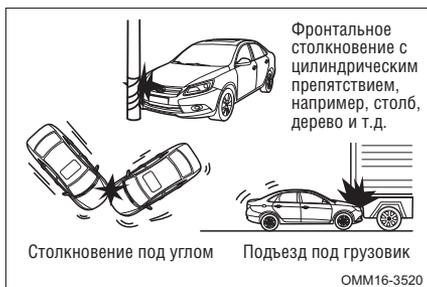
Фронтальные подушки безопасности могут не сработать, если автомобиль столкнулся со столбом, который не может быть сломан, при подъезде под грузовой автомобиль или другое препятствие, либо в случае удара автомобиля под углом, как показано на рисунке
