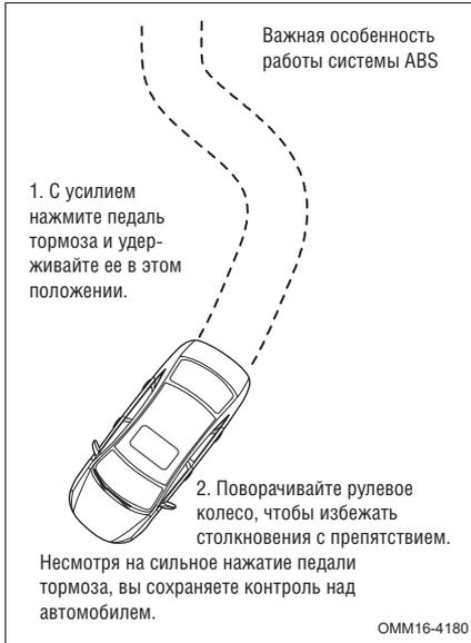
Антиблокировочная система (ABS) срабатывает немедленно при резком торможении; при этом сохраняются тормозные качества и управляемость автомобиля. При достаточном расстоянии до препятствий вы даже сможете объезжать их.
