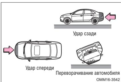
Как правило, боковые подушки безопасности и надувные шторки безопасности не срабатывают при ударе автомобиля спереди или сзади, при опрокидывании автомобиля или при ударе автомобиля сбоку на относительно малой скорости.
