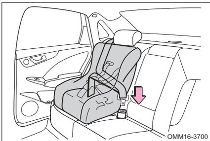
2. Пропустите ремень безопасности сквозь детское удерживающее устройство или вокруг него, в соответствии с инструкциями изготовителя, и вставьте запорную скобу в замок. Не допускайте скручивания ленты ремня безопасности. С усилием натяните поясную ветвь ремня.
