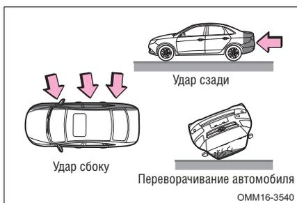
Фронтальные подушки безопасности обычно не срабатывают при ударе сбоку или сзади, переворачивании автомобиля или фронтальном столкновении на небольшой скорости. Но, всякий раз, когда столкновение любого типа вызывает достаточное продольное замедление автомобиля, фронтальные подушки безопасности могут сработать.
