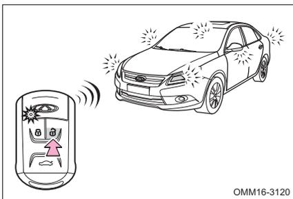
Нажмите кнопку отпирания на «интеллектуальном» ключе (пульте дистанционного управления) для отпирания замков всех дверей. При этом все указатели поворота мигнут дважды. Противоугонная система выключена, и индикатор противоугонной системы гаснет.
