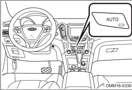
При нажатии кнопки AUTO включается индикатор, встроенный в кнопку, а на жидкокристаллическом дисплее появляется слово «AUTO» (Автоматический режим). При этом режим распределения воздуха, скорость вращения вентилятора и режим «рециркуляция воздуха/подача наружного воздуха» будут изменяться автоматически в соответствии со значением температуры воздуха в салоне, заданным пользователем.
