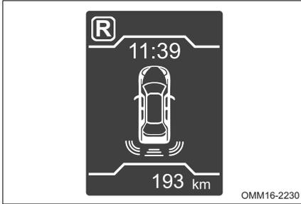
Если выключатель (замок) зажигания находится в положении ON, то при включении передачи заднего хода на многофункциональном дисплее отображаются данные системы помощи при движении задним ходом.
